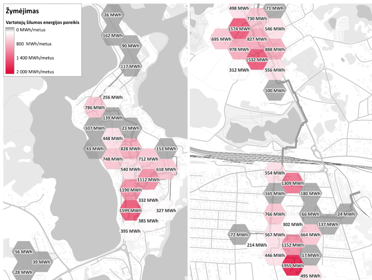
6 PAV. ŠILUMOS ENERGIJOS VARTOJIMO TANKIS TAKUOSE IR LENTVARIJE
